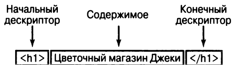
Рис. 2.2. Структура простого HTML-элемента
