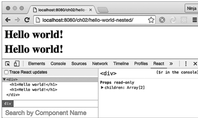
Рис. 2.4. Контейнер <div> для вложенных одноуровневых элементов h1 в React DevTools
