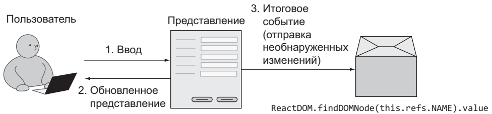
Рис. 7.12. Использование неуправляемого элемента без отслеживания изменений (вместо чего выполняется обращение к значениям по ссылке)
