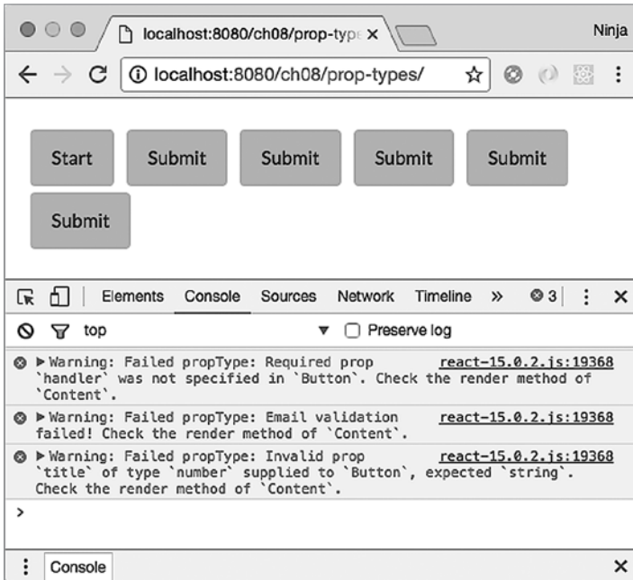
Рис. 8.2. Предупреждения, обусловленные неверным типом свойств
