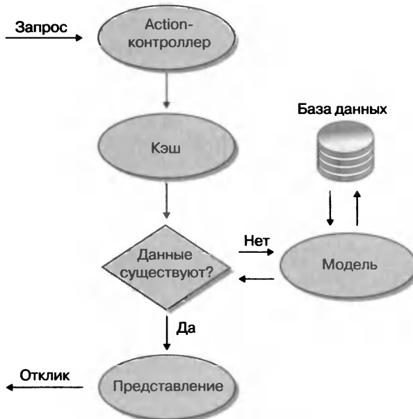
Рис. 12.8. Блок-схема функционирования кэша
