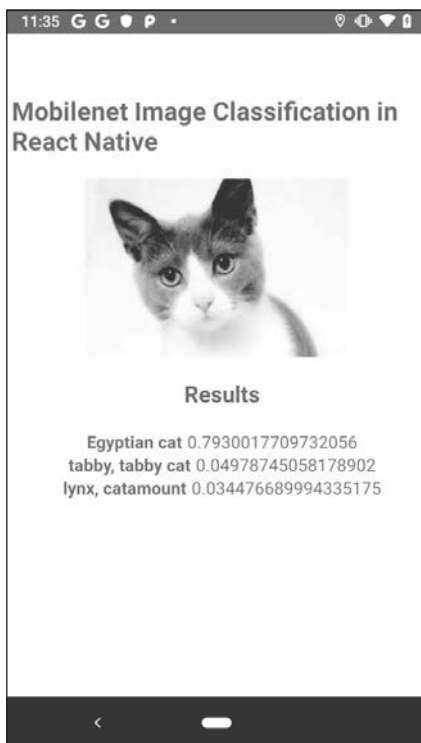
Рис. 12.6. Снимок экрана примера нативного приложения Android, созданного с помощью React Native. В данном случае модель MobileNet TensorFlow.js выполняется внутри нативного приложения
