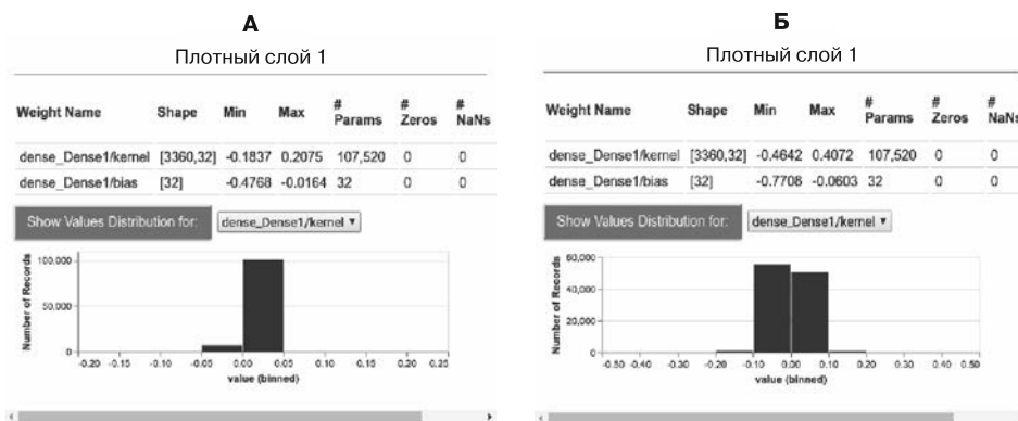
Рис. 8.5. Распределение значений в ядре с L2-регуляризацией (блок А) и без нее (блок Б). Данная визуализация создана с помощью функции tfvis.show.layer() . Обратите внимание на различные масштабы осей X двух гистограмм
