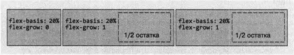
Рис. 5.9. Оставшаяся ширина распределяется равными долями между элементами с одинаковыми значениями свойства flex-grow
