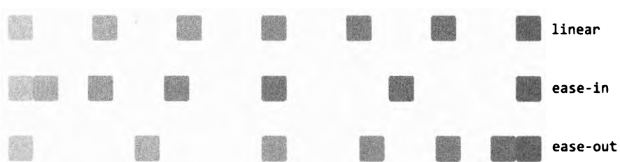
Рис. 14.3. Переход linear задает движение с постоянной скоростью, с ease-in движение ускоряется, а с ease-out — замедляется
